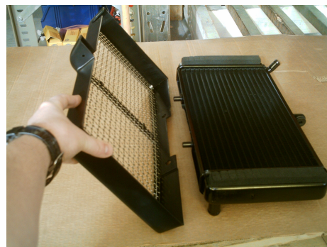
Bild 10. Kylarkåpa monteras på kylare.
