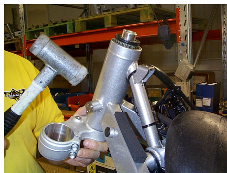
Bild 6. Montage av nedre gaffelkrona.
