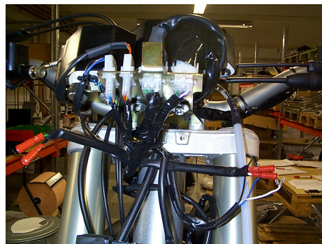
Bild 11. Kabelstammen i kontaktbryggan.
