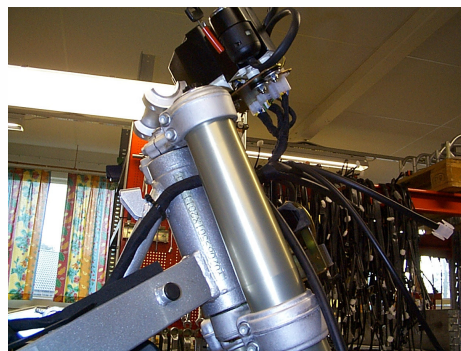
Bild 12. Kabelstam utmed styrhuvud.
