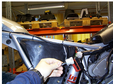
Bild 8. Kabeldragning fram till kabelstam.
