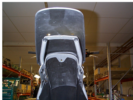
Bild 6. Kåpa och sprutskydd.
