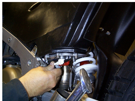
Bild 3. Anslutning av bränsleslangar.
