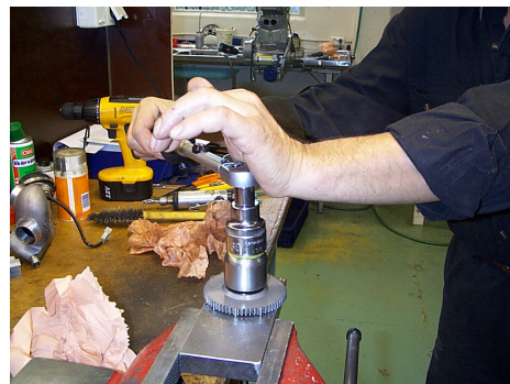
Bild 22. Åtdragning av momentbegränsare.
