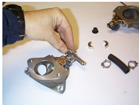
Bild 34. Låsning av t-stycken.
