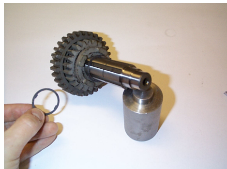
Bild 9. Placering av stödbrickors taggar.
