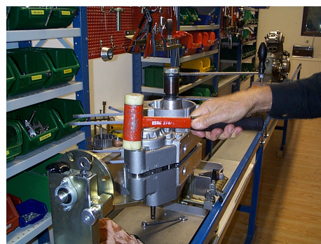
Bild 8. Nedknackning av höger vevhushalva.
