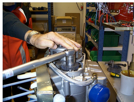
Bild 9. Åtdragning av primärdrev
