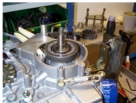
Bild 12. Frihjul och nållager i medbringare.
