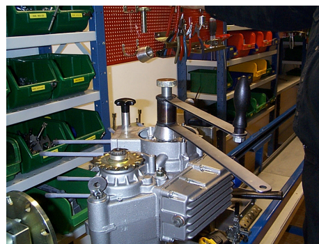
Bild 4. Dragverktyg för kamdrev.
