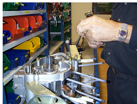
Bild 6. Smörjning av nållager.
