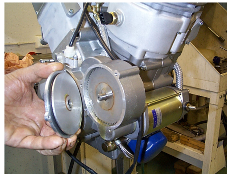
Bild 14. Momentbegränsare och lock.
