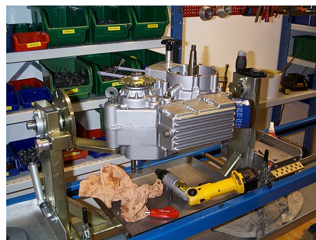
Bild 2. Oljesump med magnetplugg.
