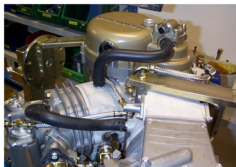
Bild 12. Kylslangar mellan cylindrar och pump.
