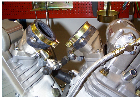
Bild 13. Insugssystem, injektorer och gummin.
